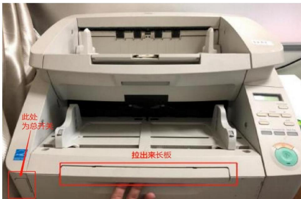
将需要扫描的答题卡**整齐、平整**地放在放在扫描仪的进纸口，并用挡纸板卡住答题卡，不让答题卡随意左右摆动，贴有条形码的一侧朝外放置，且所有答题卡放置方向要一致。
